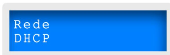
A configuração do IP de rede no Inner pode ser definida como DHCP (dinâmico) ou IP fixo. Por padrão o DHCP vem desabilitada.
